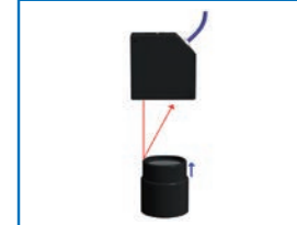
数码相机镜头延伸管检查
